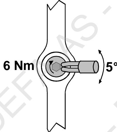
Kontrollieren das der Wärmer nicht herausgezogen bzw. verdreht werden kann. Verunreinigte oder alte Kühlflüssigkeit muss erneuert werden.
