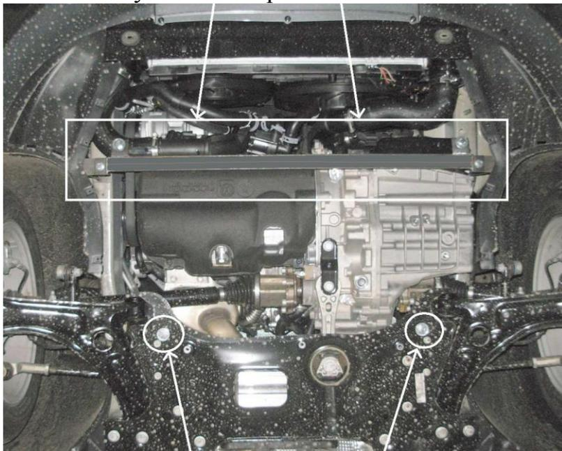
Места установки задних креплений для стального подрамника.
