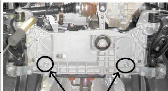
Места установки задних креплений для алюминиевого подрамника.
