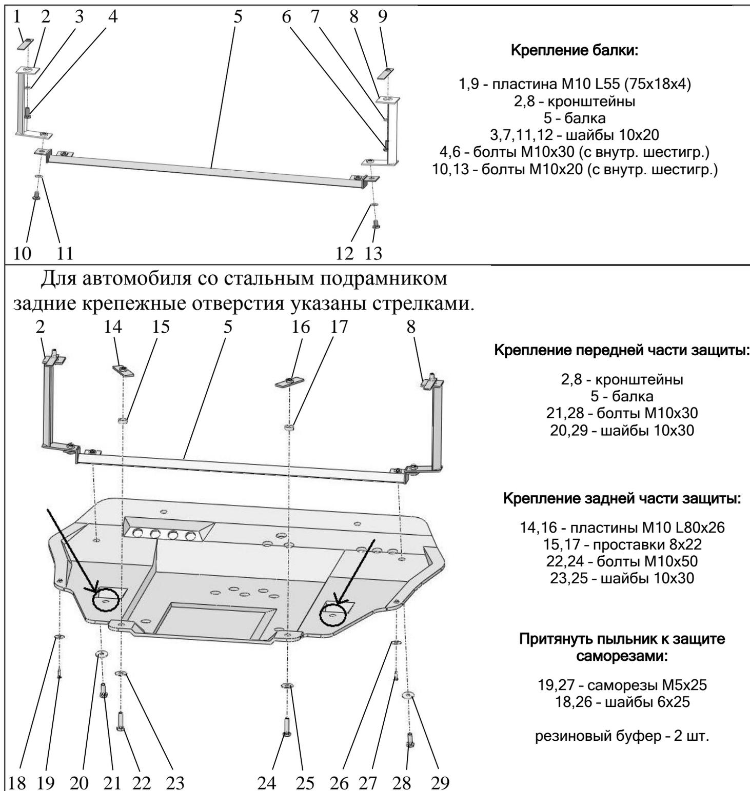
**Момент затяжки резьбовых соединений M10 не более 2,5 кг·м**
