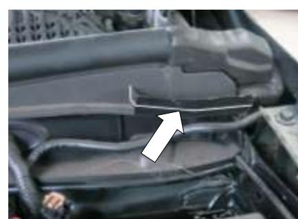
2. Открутить верхнюю гайку крепления капота. Установить кронштейн капота, уперев его в ребро жесткости. Затянуть гайку ключом №13 с усилием 23 Нм.
