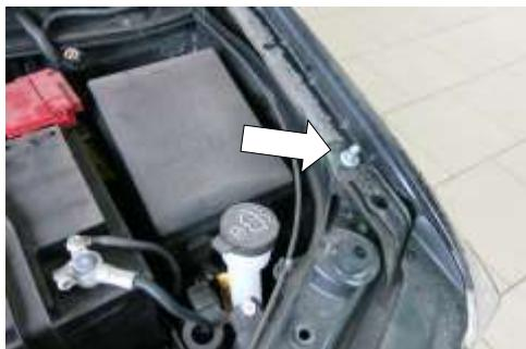
1. Открутить болт крепления крыла и установить вместо него болт-шарнир с шайбой, как показано на рисунке.
