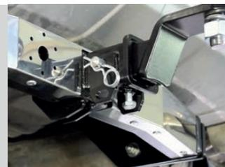
Тип соединения: шаровый; Диаметр сцепного шара: 50 мм.; Масса комплекта ТСУ 09111501: 23 кг.
