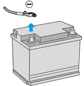
Перед началом работ отключите минусовую клемму от аккумуляторной батареи автомобиля! Отключение аккумуляторной батареи может повлечь блокировку аудио устройства (штатная магнитола автомобиля) или других блоков автомобиля и может потребоваться необходимость введения секретного или другого кода. Перед началом работ убедитесь, что вам известны последствия при данных действиях. В приоритетном порядке, руководствуйтесь инструкцией по эксплуатации автомобиля.
