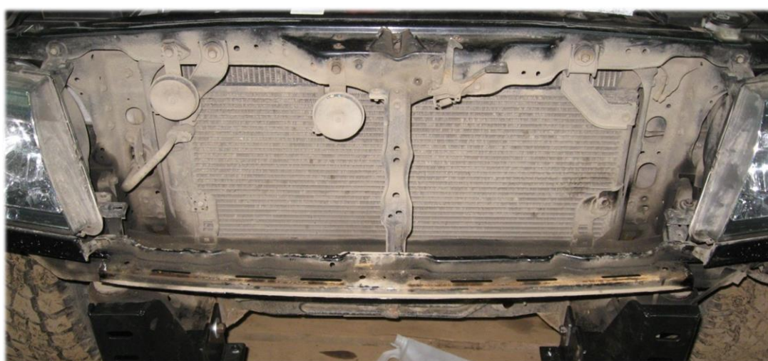
7. Совместить кронштейны бампера с кронштейнами крепления к раме. Закрепить с помощью прилагаемого крепежа.
