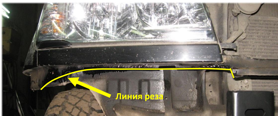
Итоговый вид кузова, подготовленного к установке бампера.
