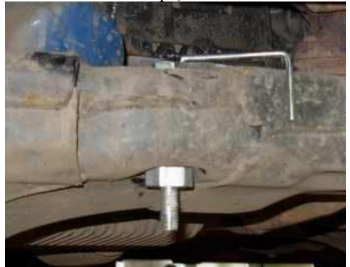
Установлена правая (со стороны пассажира) шпилька
