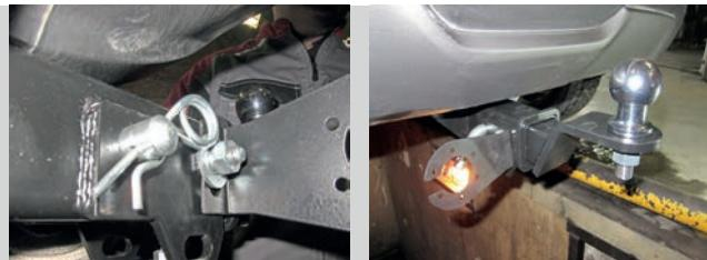
Тип соединения: шаровый; Диаметр сцепного шара: 50 мм.; Масса комплекта ТСУ 11031501: 13 кг.
