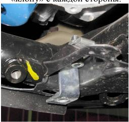
Для автомобиля с двигателем 2.0 кронштейны должны быть установлены приваренной гайкой вперед, по ходу движения автомобиля.
