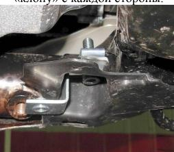
Для автомобиля с двигателем 2.4 кронштейны должны быть установлены приваренной гайкой к центру автомобиля.
