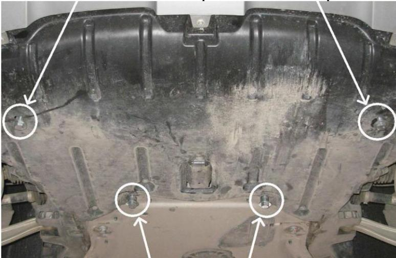
Задняя часть защиты двигателя крепится к автомобилю через проставки 15x22.
