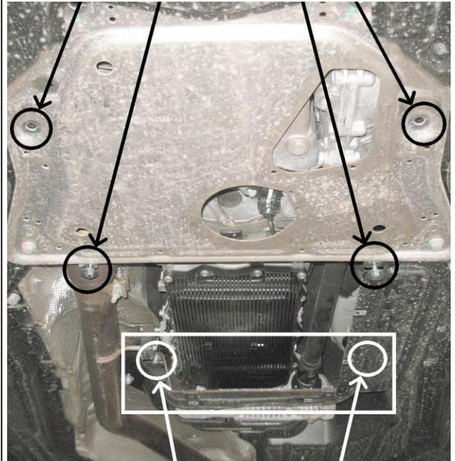
Пластина крепится штатными болтами М10 к подрамнику КПП.
