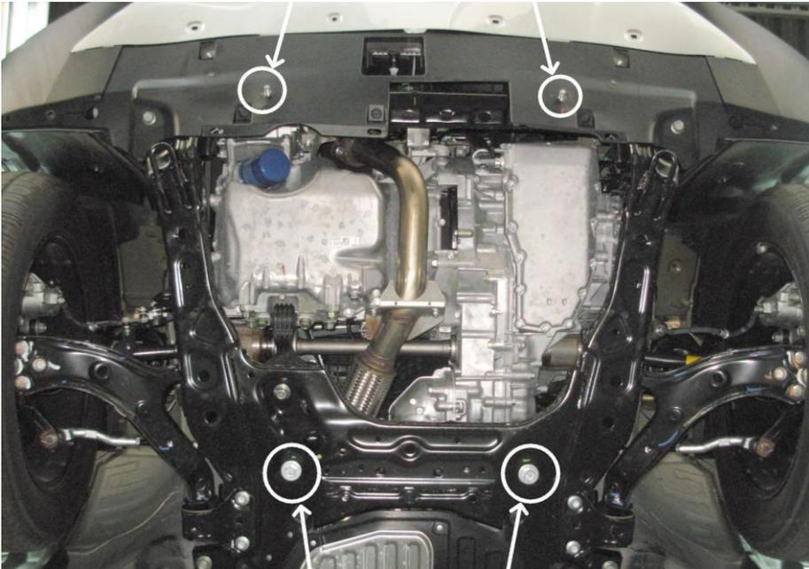
После установки кронштейнов вернуть пыльник на место и сделать в нем вырезы под шпильку.
