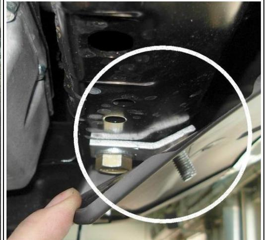
Задняя часть защиты крепится через проставки в штатные резьбовые отверстия.
