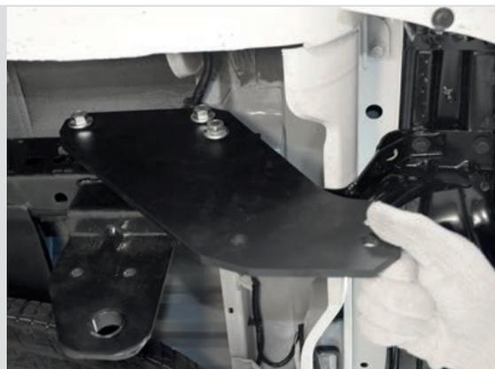
**ШАГ 3.** Отрегулируйте положение центрального кронштейна относительно бампера автомобиля, обеспечив минимальный зазор 10 мм. Затяните все резьбовые соединения начиная с боковых кронштейнов. Установите съемный шар и закрепите его болтами M16x60 через шайбы на 16 и шайбы пружинные на 16 с помощью гаек M16.
