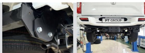
Тип шара «F»; Тип соединения: шаровый; Диаметр сцепного шара: 50 мм.; Масса комплекта TCU GWW991102: 25,3 кг.
