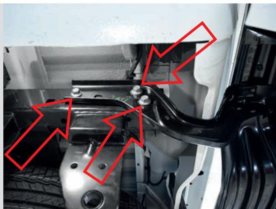
**ШАГ 2.** Установите кронштейн боковой, совместив отверстия кронштейна с резьбовыми отверстиями крепления кронштейна бампера. Соедините всё с помощью трёх болтов M12x1,25x45 с юбкой из комплекта поставки. Повторите на другой стороне автомобиля. Соединения не затягивайте.
