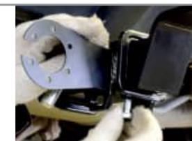
**ШАГ 6.** Установите съёмный шар в сборе и закрепите его пальцем гнутым гальванизированным со шплинтом пружинным игольчатым. Затяните фиксирующий болт M10x20 снизу, он используется для исключения технологических люфтов съёмного шара и только в ненагруженном состоянии! Перед сцепкой болт демонтировать! Установка завершена.
