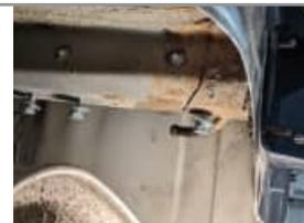
**ШАГ 3.** Установите правый кронштейн крепления аналогичным способом. Закрепите кронштейны на штатных шпильках штатными гайками с фланцем.
