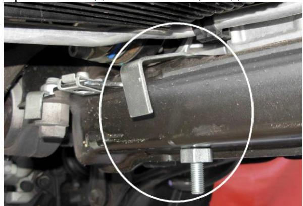
Места установки кронштейнов крепления задней части защиты КПП.
