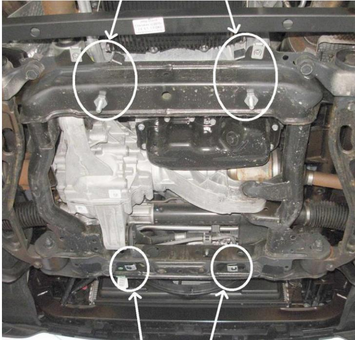
Места установки креплений передней части защиты двигателя. Вместо штатных скоб M8 крепления пыльника установить скобы M10.
