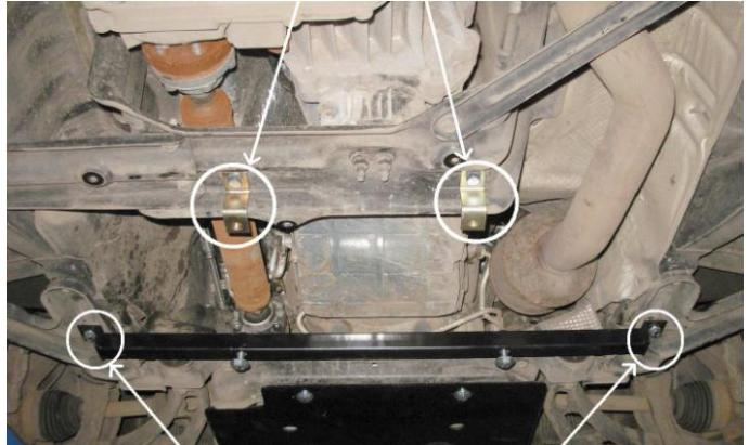
Места крепления балки.
