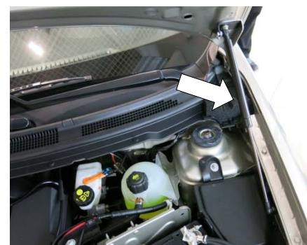
2. Установить кронштейн крыла, как показано на рисунке. Плотно прижать подгиб кронштейна к кузову и затянуть болт и гайку ключом №13 с усилием 23 Нм.
