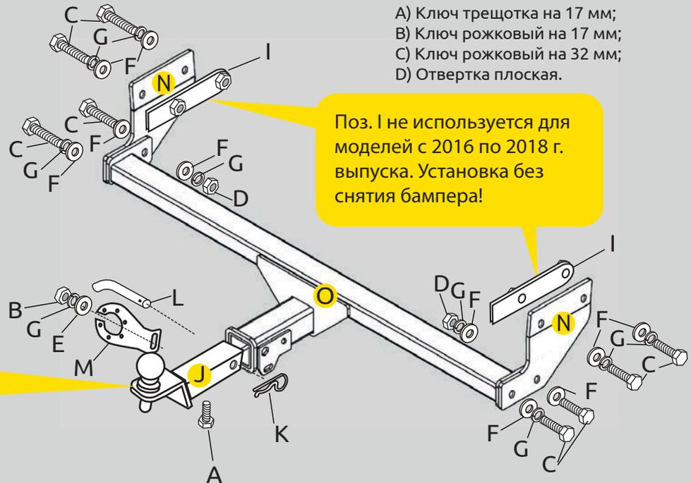
Не предназначен для установки багажных платформ с креплением на шар
