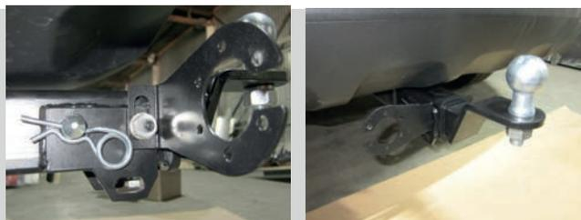
Тип соединения: шаровый; Диаметр сцепного шара: 50 мм.; Масса комплекта ТСУ 06041501: 13 кг.
