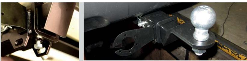
Тип соединения: шаровый; Диаметр сцепного шара: 50 мм.; Масса комплекта ТСУ 01211502: 12 кг.
