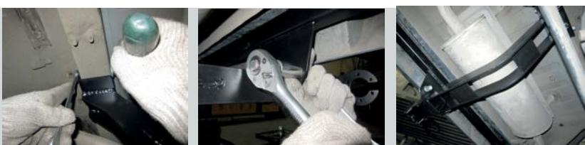
**ШАГ 5.** Установите кронштейн крепления электрической розетки (поз. Q). Установите съемный шар в сборе и закрепите его пальцем гнутым с шплинтом. Зафиксируйте съемный шар винтом M10x20 снизу. Установка завершена.
