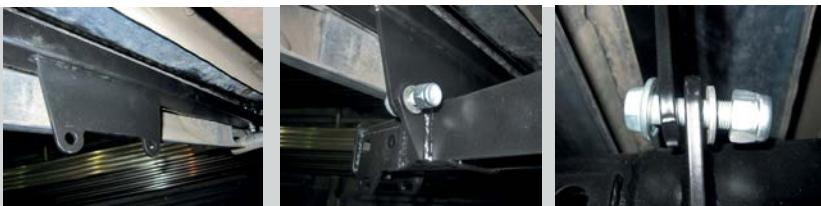
**ШАГ 3.** Совместите отверстия в кронштейне с отверстиями в лонжероне и проденьте сквозь отверстия лонжерона болты M10x90. Закрепите всё с помощью самоконтрящихся гаек M10 через шайбы M10 увеличенные.
