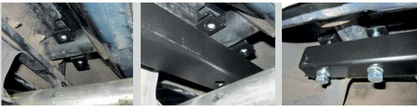
**ШАГ 2.** Для установки центрального кронштейна совместите отверстия кронштейна с отверстиями в ушках поперечной балки и соедините болтами M12x45x1,25 через шайбы M12 и самоконтрящиеся гайки M12x1,25.
