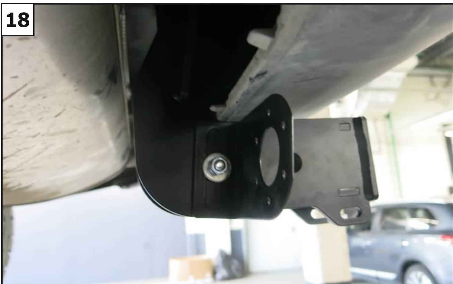
**Установить кронштейн под розетку (10) с помощью болтов M8x80 (16), шайбы 8 (24), шайбы 8 увел. (25), шайбы 8 пружинных (26) и гайки M8 (21). Момент затяжки: M8=25 Нм.**
