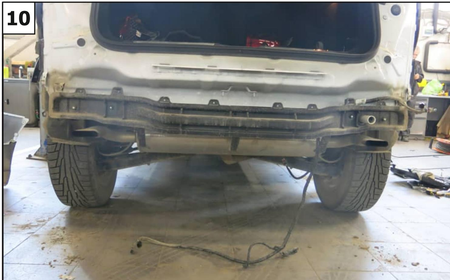
**Демонтировать проводку и антенну с усилителя бампера.**
