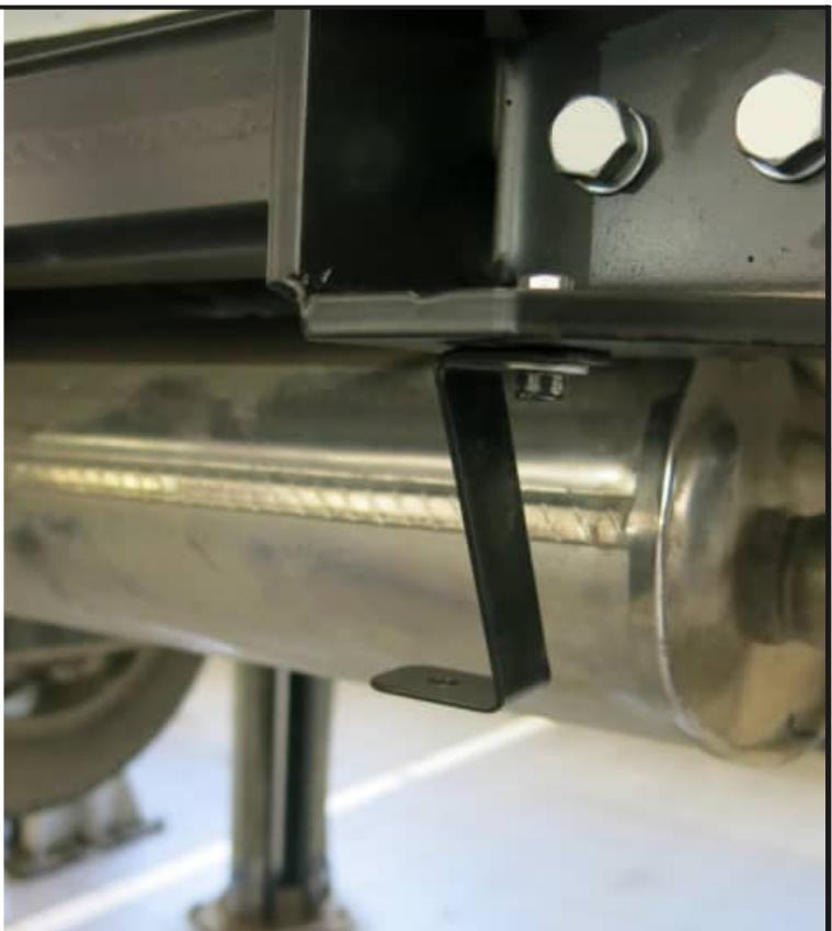
Установить левый (11) и правый (12) кронштейны бампера с помощью болтов M6x25 (15), шайб 6 (22), шайб 6 пружинных (23) и гаек M6 (20). Установить кронштейн антенны (13) по середине балки с помощью болта M6x90 (14), шайб 6 (22), шайбы 6 пружинная (23) и гайки M6 (20). После установить задний бампер в обратной последовательности.
