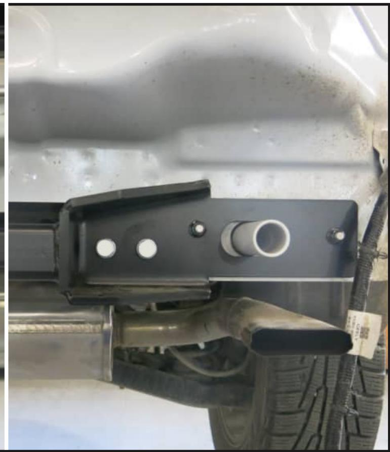
**Установить балку (1) закрепив ее к задней панели автомобиля с помощью штатных гаек крепления усиления бампера. Затем закрепить балку к установленным кронштейнам с помощью болтов M10x1,25x35 (19), шайб 10 (27) и шайб 10 пружинных (29).**
