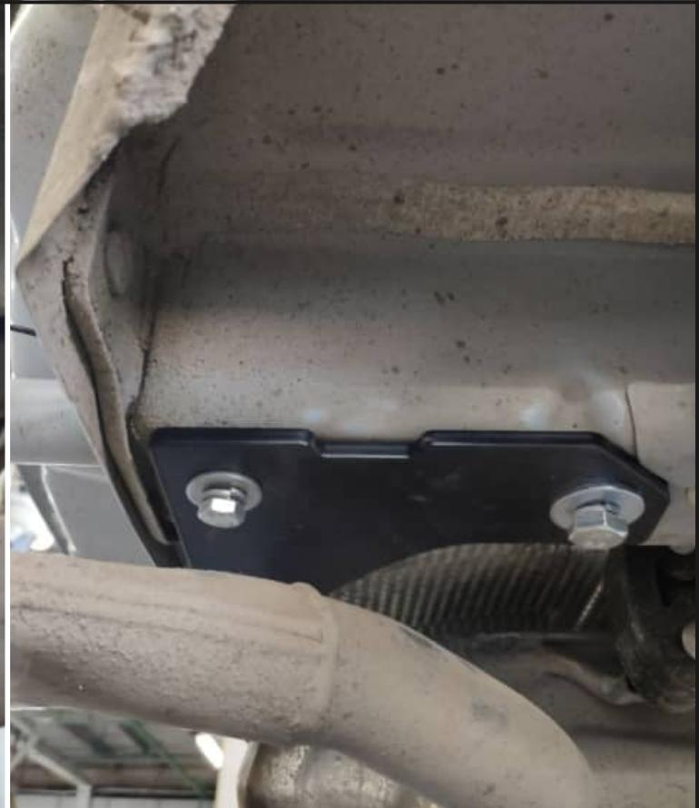
**Установить левый (2) и правый (3) кронштейны, закрепив к лонжеронам с помощью установленных закладных (4),(5), болтов M10x1,25x35 (19), болтов M8x30 (17), шайб 10 увел. (28), шайб 10 пружинных (29), шайб 8 увел. (25), шайб 8 пружинных (26).**
