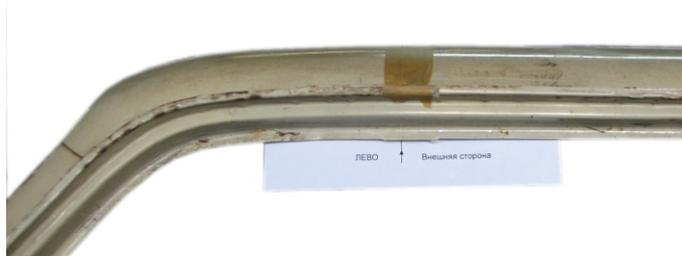
Рис.4 Установка шаблонов. Вид снаружи автомобиля
