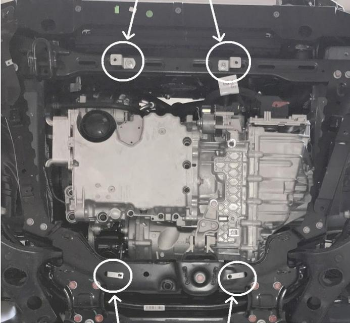
Места установки креплений задней части защиты (используются штатные отверстия крепления пыльника). С водительской стороны скоба чуть длиннее. Рекомендуется обтянуть скобки после установки, чтобы их зафиксировать, и чтобы хватило длины болта.
