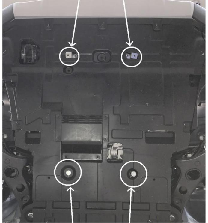
Для крепления задней части защиты с водительской стороны дополнительно устанавливается проставка между защитой и пыльником.
