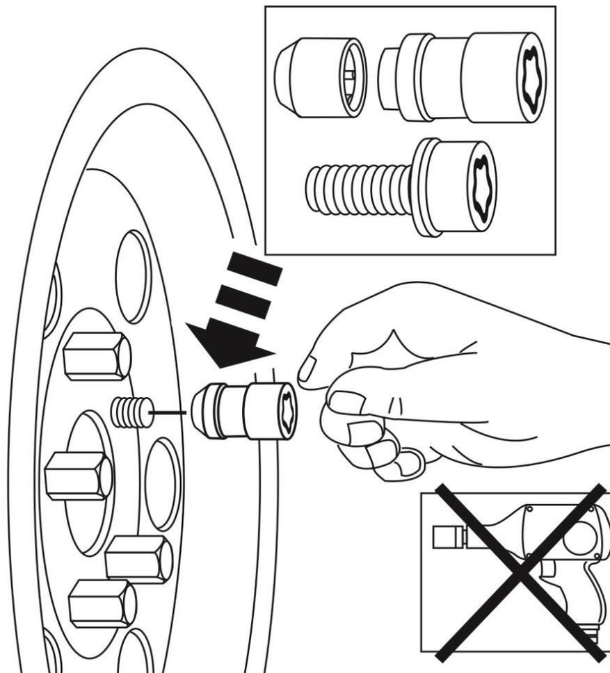
Смонтируйте фиксатор колеса McGard вручную на каждом колесе. Следите за тем, чтобы кодировка ключа устанавливалась точно на предусмотренную для этого кодировку фиксаторов колеса McGard.
