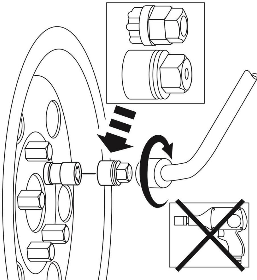
Затяните каждый фиксатор колеса McGard с помощью входящего в комплект поставки ключа и динамометрического ключа до крутящего момента, указанного в руководстве к транспортному средству, нажимая на динамометрический ключ по оси во избежание соскальзывания или перекоса входящего в комплект поставки ключа. Поверните колесо вручную, чтобы проверить, свободно ли оно вращается, и не возникло ли каких-либо ограничений.
