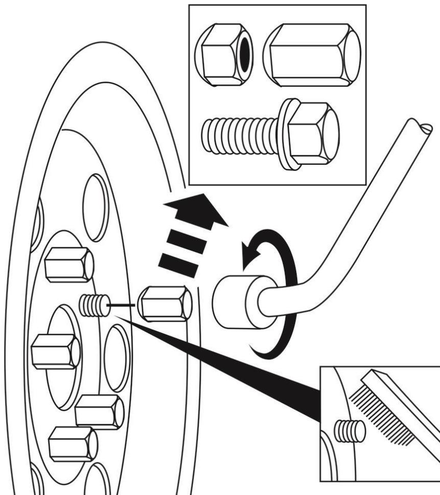
Снимите оригинальную гайку крепления колеса/болт крепления колеса с каждого колеса транспортного средства. При последующей смене колеса фиксатор колеса – гайка/болт – всегда отвинчивается в первую очередь и монтируется в последнюю очередь.
