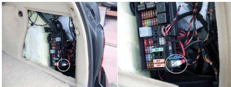
**NOTA:** Cuando se efectúe la instalación eléctrica extremar la precaución para no hacer masa con el tornillo señalado en la imagen. Está situado tras el guarnecido de la parte derecha del maletero.
