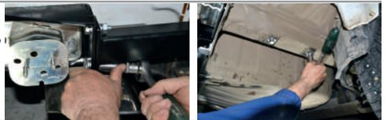
**ШАГ 5.** Установите усилитель заднего бампера на штатные метизы. Установите задний бампер и задние фонари согласно инструкции по ремонту автомобиля. Установите шар в сборе (Поз. М). Зафиксируйте шар в сборе с помощью пальца с клипсой.
