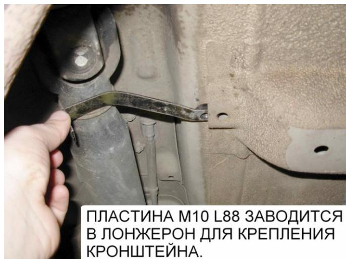
ПЛАСТИНА М10 L88 ЗАВОДИТСЯ В ЛОНЖЕРОН ДЛЯ КРЕПЛЕНИЯ КРОНШТЕЙНА.
