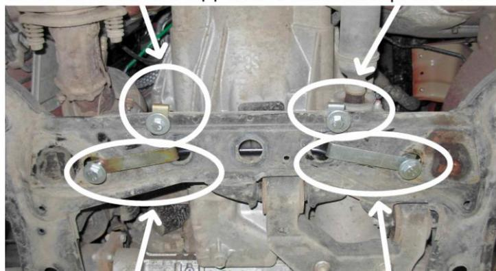
КРЕПЛЕНИЕ ЗАДНЕЙ ЧАСТИ ЗАЩИТЫ ДВИГАТЕЛЯ
