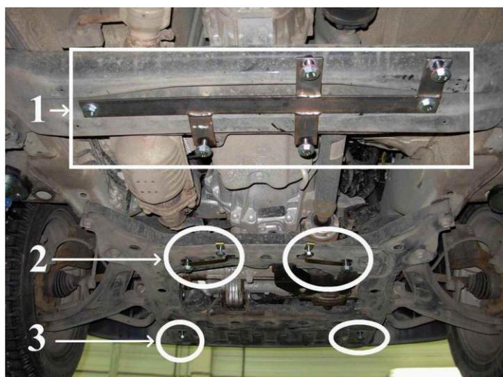
Для установки креплений передней части защиты двигателя потребуется вырезать пластиковую бобышку пыльника.
