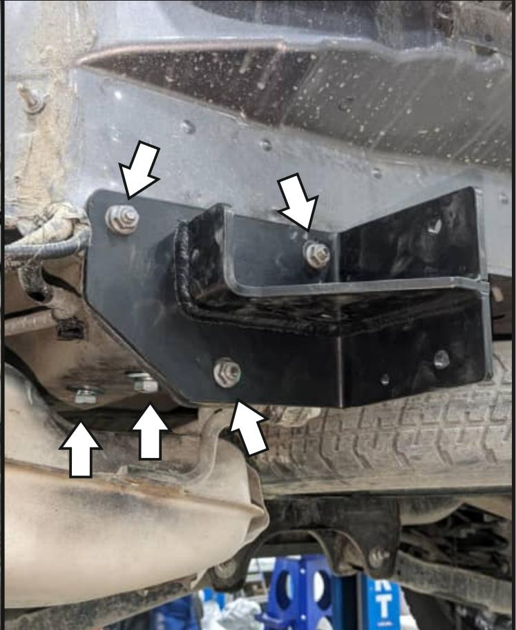
Установить кронштейн левый (2) в лонжерон, закрепив его с помощью штатных гаек, болтов M12x1,25x40 (14), шайб 12 пружинных (24) и шайб 12 увел. (26). Кронштейн правый (3) установить аналогично.
