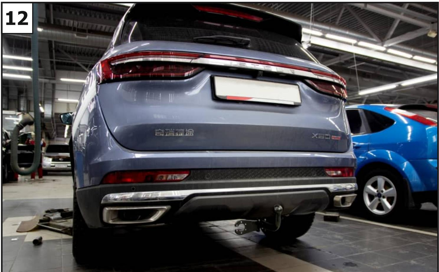
**Установить кронштейн под розетку (9) и крюк (10) с помощью болтов M12x1,25x70 (15), шайб 12 пружинных (24), шайб 12 (25) и гаек M12x1,25 (18). Затянуть все резьбовые соединения. Момент затяжки: M12=81 Нм.**
