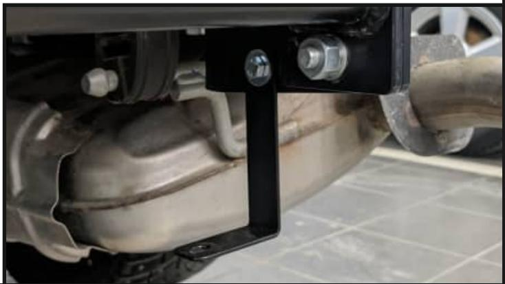
Установить кронштейн антенны (8), кронштейны бампера (6) и кронштейн бампера центральный (7) с помощью болта M6x60 (12), болтов M6x20 (11), шайб 6 пружинных (19), шайб 6 (20), шайб 6 увел. (21) и гаек M6 (16) (Кронштейн центральный (7) на X70 не устанавливается).
