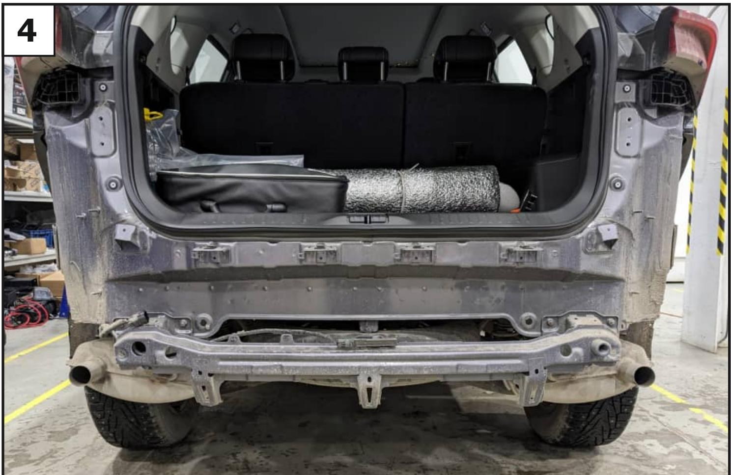
Снять задний бампер, отключив разъем электропроводки.
