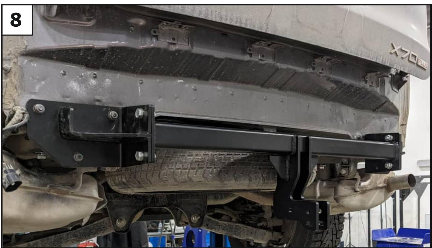
Установить балку (1), закрепив её к кронштейнам с помощью болтов M10x1,25x30 (13), шайб 10 пружинных (22), шайб 10 (23) и гаек M10x1,25 (17). Отрегулировать положение балки относительно центра автомобиля. Затянуть все резьбовые соединения: сначала балку с кронштейнами, затем кронштейны с задней панелью, потом с лонжеронами. Моменты затяжки: M10=47 Нм; M12=81 Нм.
