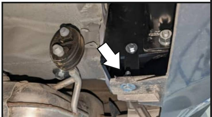
**Закрепить антенну на кронштейне антенны (8). Установить бампер в обратном порядке, закрепив к кронштейнам бампера (6) и к кронштейну бампера центральному (7) с помощью болтов M6x20 (11), гаек M6 (16), шайб 6 пружин. (19) и шайб 6 увел. (21).**
