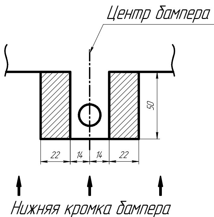
Выполнить на бампере вырез под крюк согласно схеме.
