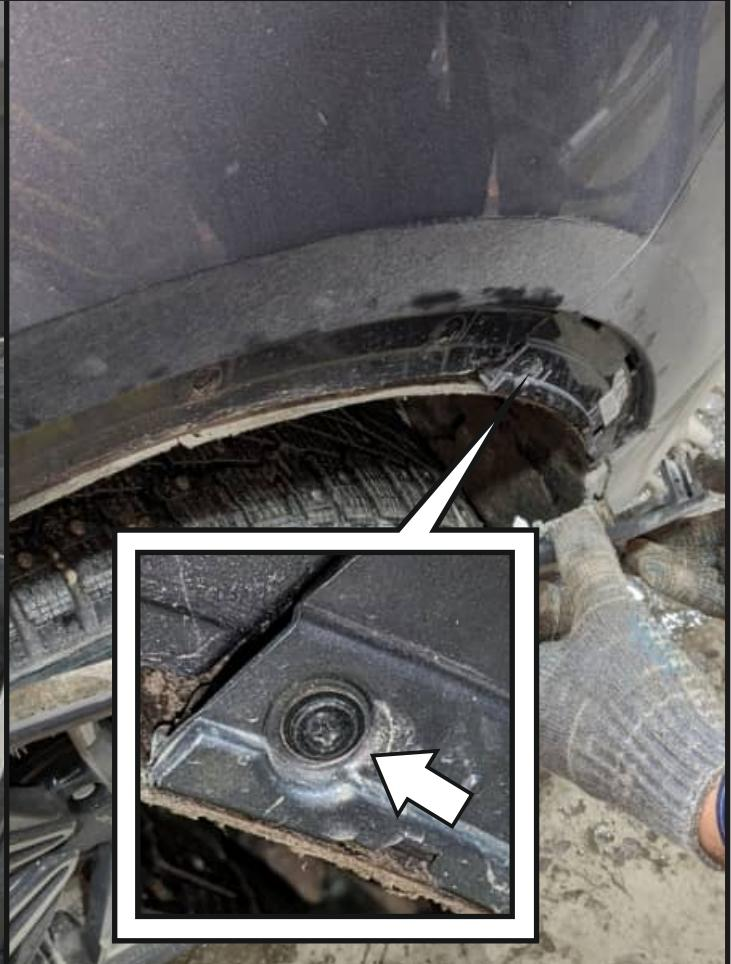
Открутить винты крепления боковой накладки. Демонтировать боковую накладку и выкрутить винт крепления бампера. С другой стороны аналогично.
