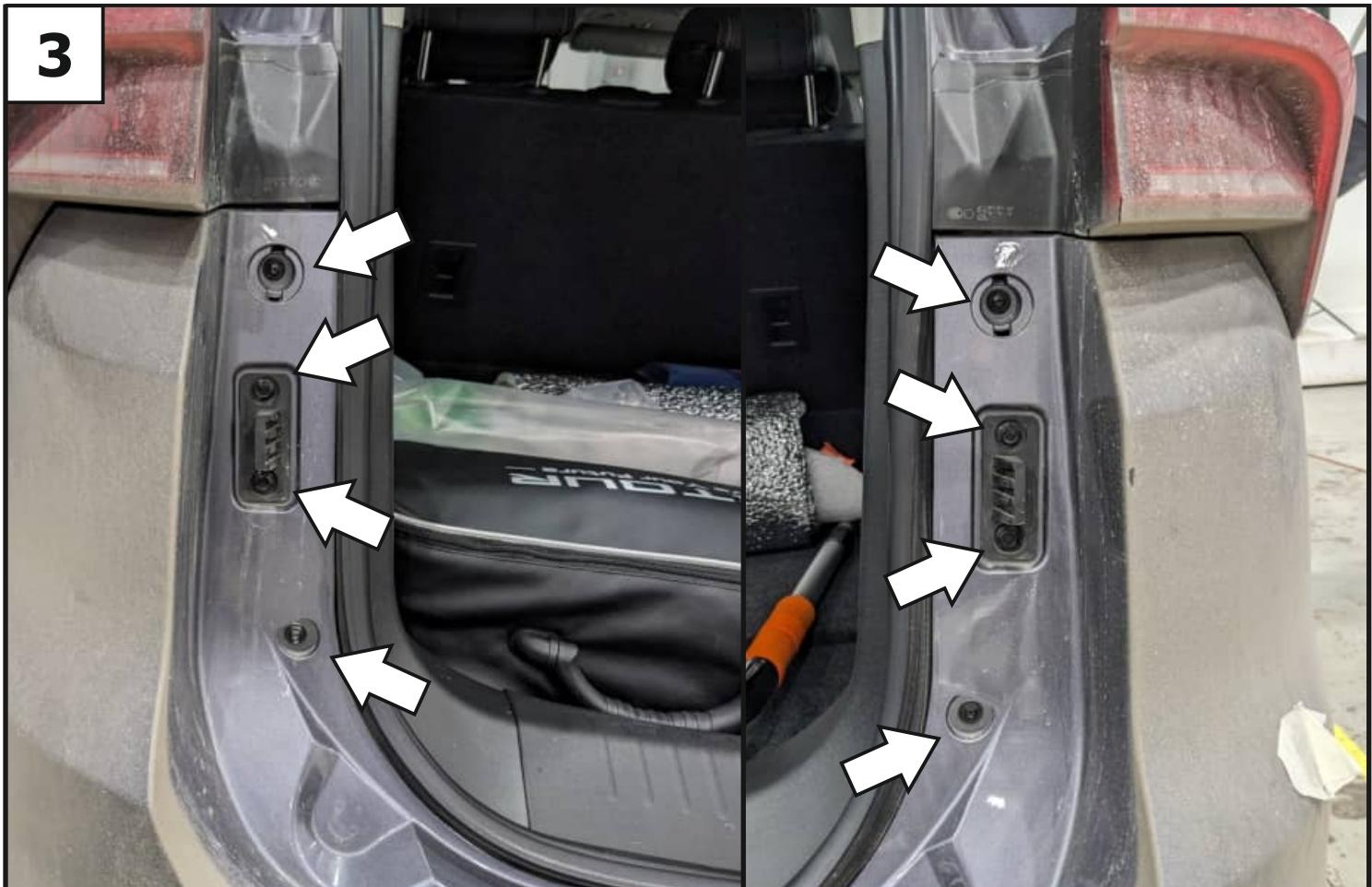
Снять заглушки и выкрутить винты крепления бампера.
