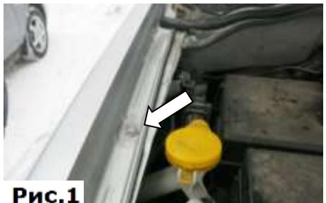
1. Торцевой головкой №10 выкрутить болт крепления крыла, (Рис.1).
