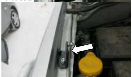
2. Установить кронштейн крыла, зафиксировав его винтом M6x20 с шайбой 6. Прижать подгиб кронштейна к крылу. Затянуть винт M6x20 вставкой-битой HEX5мм с усилием 9 Нм,(Рис.2).
