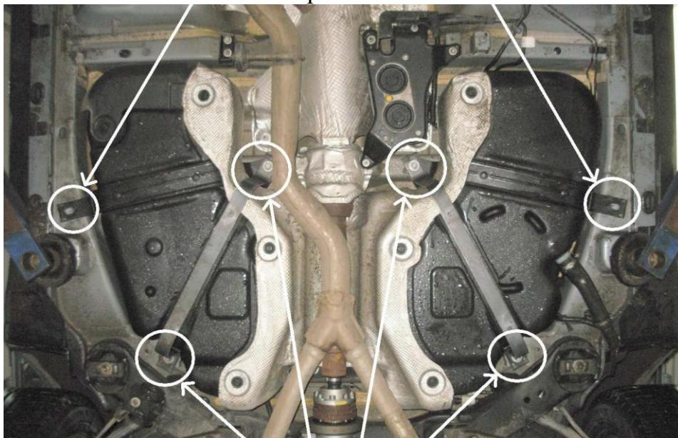
Места крепления кронштейнов. Кронштейны устанавливаются поверх штатных кронштейнов и крепятся штатными болтами M10. Обтягивать крепления кронштейнов только после установки защит.
