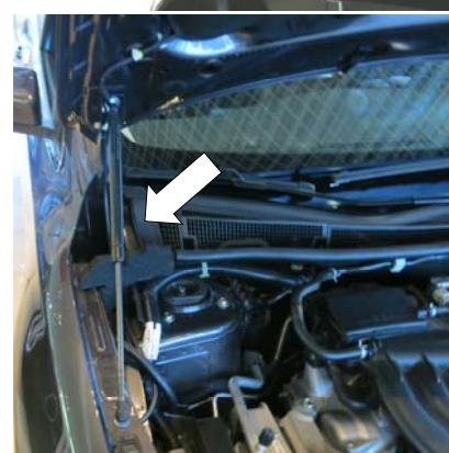
2. Установить болт-шарнир с шайбой на крыло как показано на рисунке. Затянуть болт ключом №10 с усилием 9 Нм.
