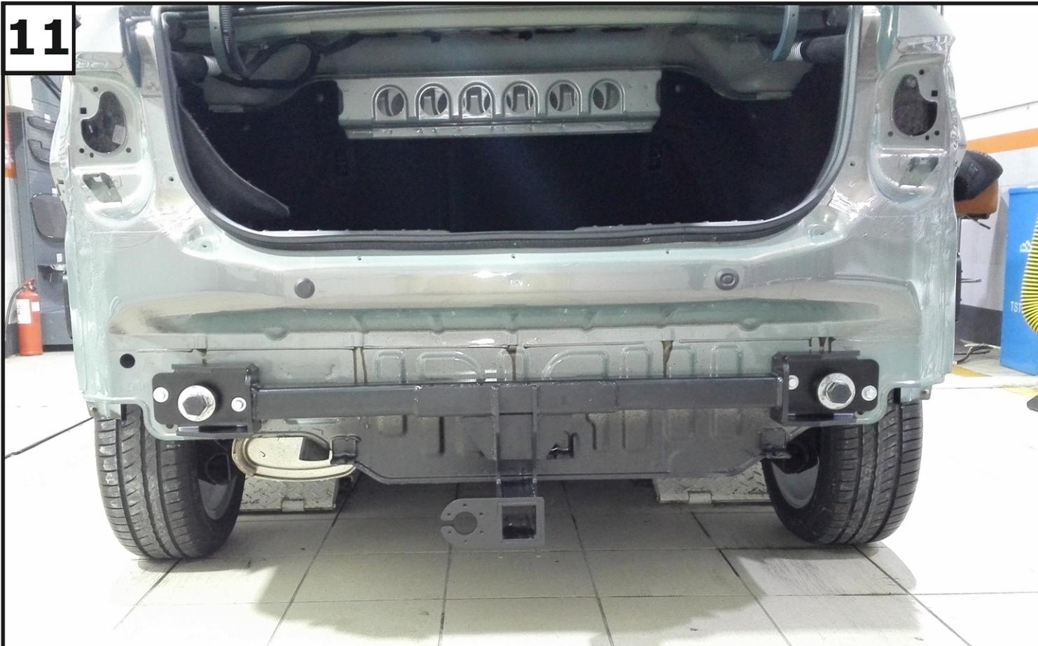
**Затянуть все резьбовые соединения. Моменты затяжки: M8=25 Нм, M22=95 Нм.
