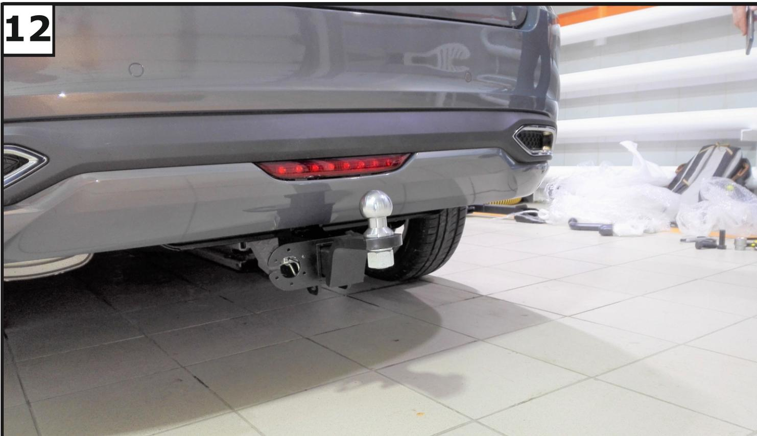
**Установить переходник (2), закрепив с помощью штифта (4) и шплинта (5). Зафиксировать переходник болтом M10x20 (6) - фиксацию использовать только без нагрузки. Установить на переходник шар (3), закрепив гайкой M24 (15) с шайбой 24 пружинной (14). Момент затяжки M24=95 Нм.**
