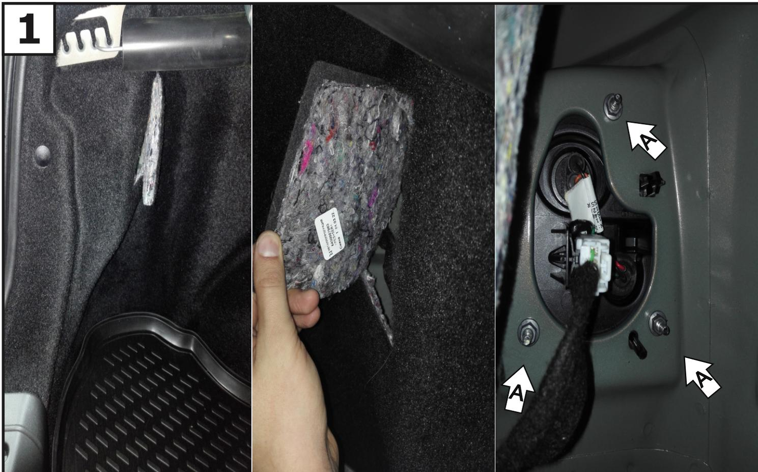
**1** Открутить 3 гайки (А) крепления левого и правого задних фонарей, через лючки в обшивке багажного отделения.
