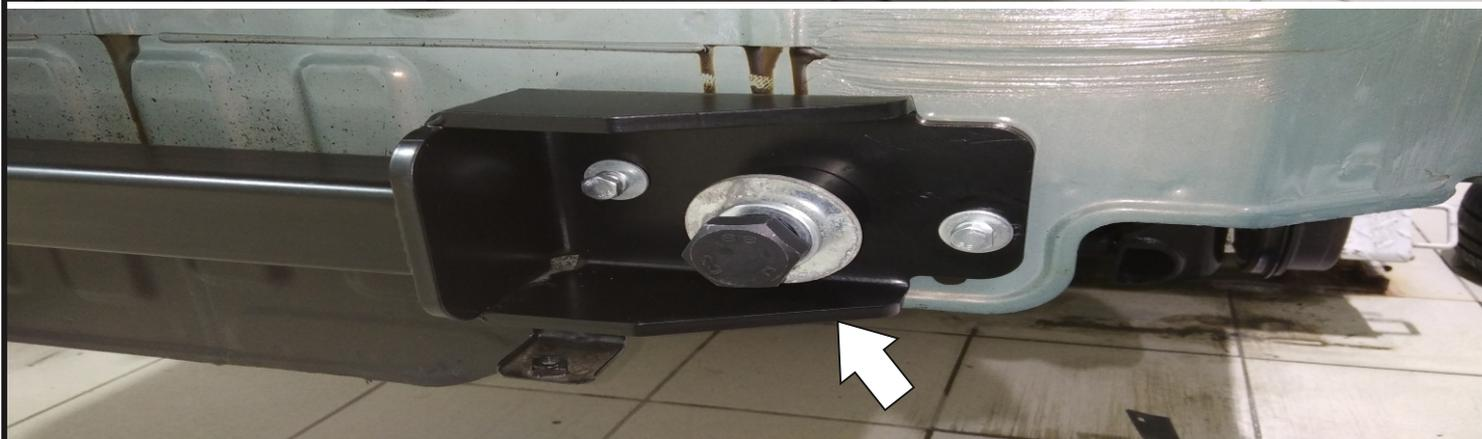
Закрепить установленную балку (1) с помощью болтов M22x1.5x50 (7), шайб 22 пружинных (8), шайб 22 увел. (9).
