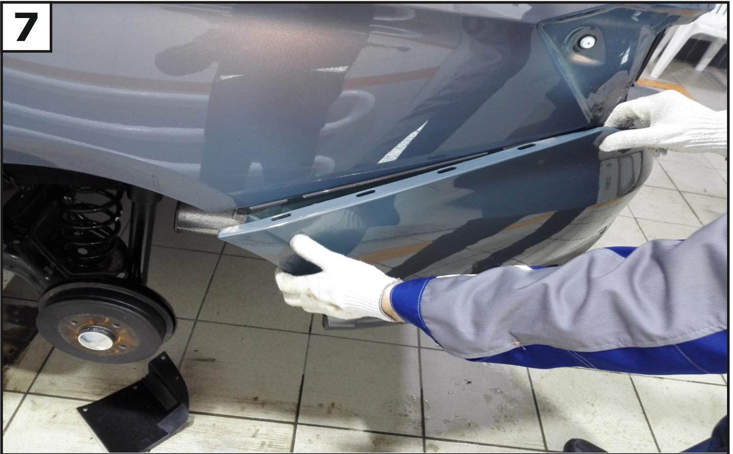
Отщелкнуть защелки крепления бампера с левой и правой стороны. После демонтировать бампер с автомобиля.
