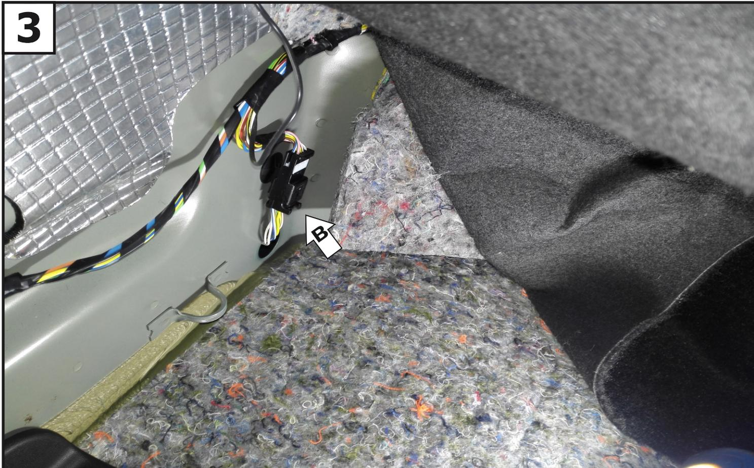
Под обшивкой на задней панели отсоединить разъем (В) задних парктроников.
