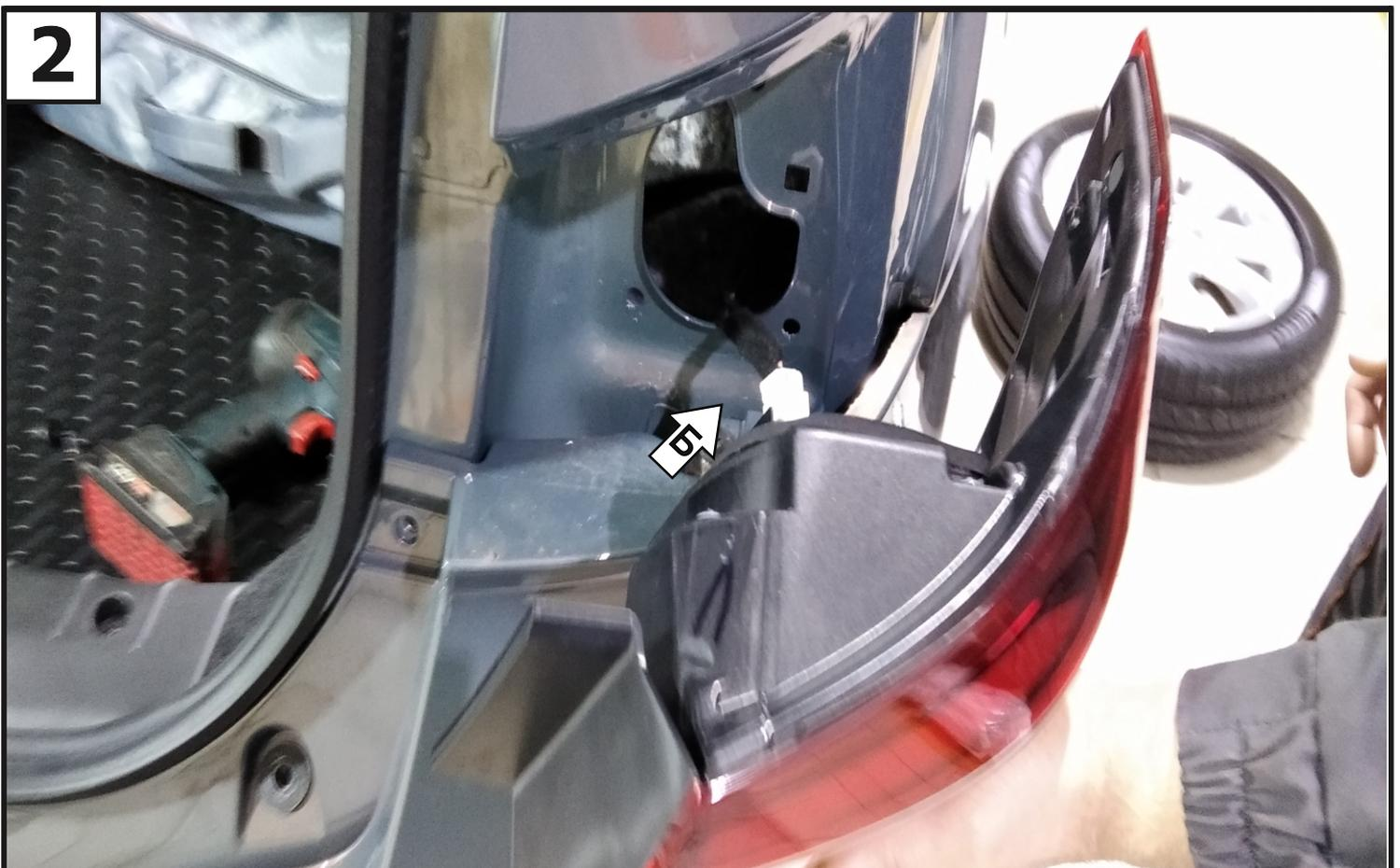
**2** Снять левый и правый задние фонари и отсоединить разъемы (Б).
