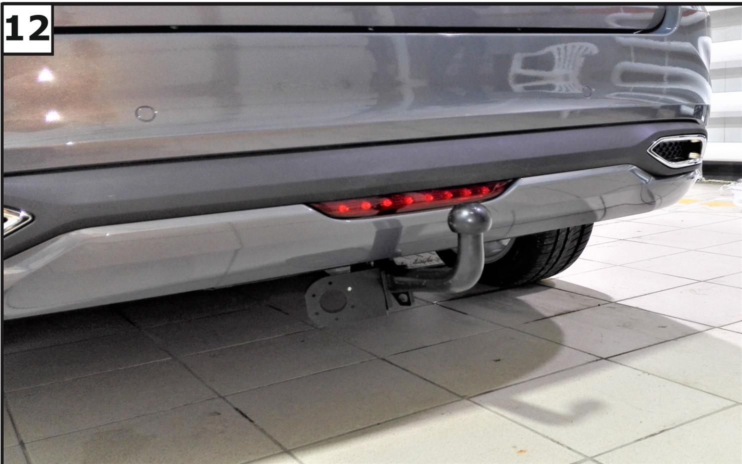
**Установить подрозетник (3) и крюк (2) с помощью болтов M12x1.25x70 (11), шайб 12**
