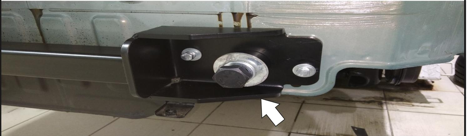
Закрепить установленную балку (1) с помощью болтов M22x1.5x50 (4), шайб 22 пружинных (5), шайб 22 увел. (6).
